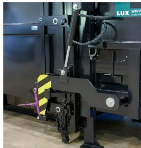
■ Detail hydraulického připojení kontejneru ke stacionárnímu lisu
