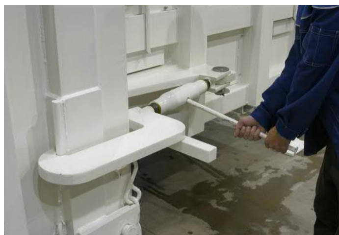
■ Detail mechanického připojení kontejneru k stacionární jednotce
