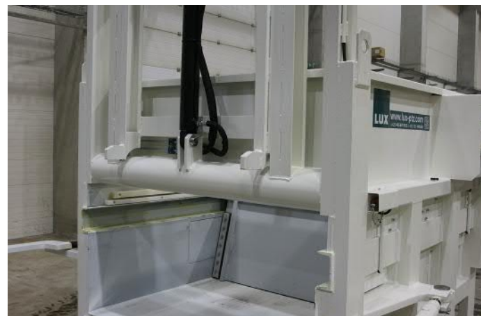
■ Mechanické připojení a hydraulické uzavírání vrat kontejneru
