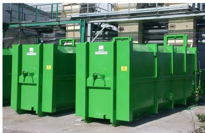
■ Stacionární lisy s přípojnými kontejnery plněné vzduchotechnickou technologií
